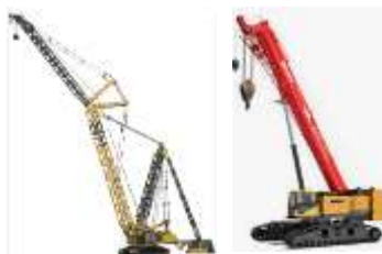
Gambar 1 Crane kapasitas 450 ton dan 50 ton
