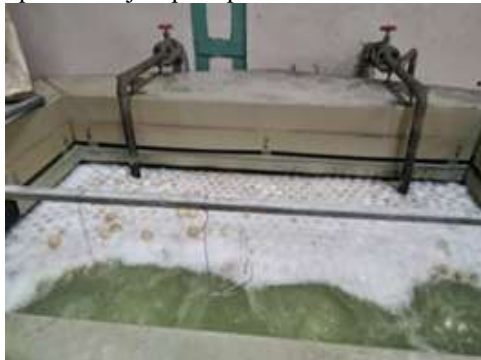
Gambar 3. Proses Perendaman Spesimen Uji dengan Cairan Alkaline
