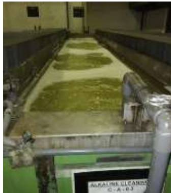
Gambar 9. Proses Perendaman Spesimen Uji dengan Cairan Alkaline
