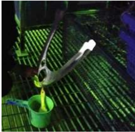
Gambar 13. Proses aplikasi cairan Penetrant .
