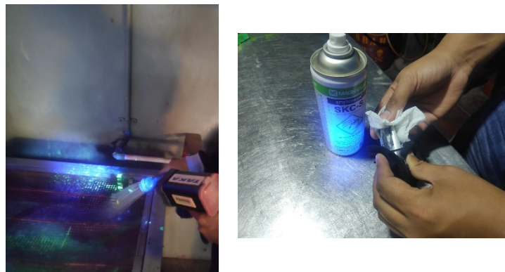
Gambar 8 Pembersihan Cairan Menggunakan Air Untuk Metode A dan menggunakan Solvent Untuk Metode C
