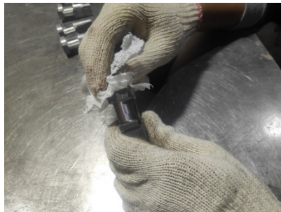
Gambar 5 Proses pembersihan Cairan Cleaner menggunakan Lap untuk Metode A dan Metode C
