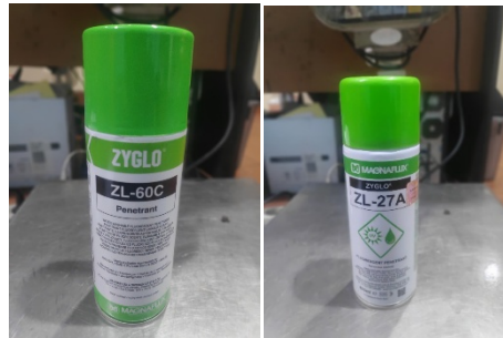
Gambar 6 Cairan Penetrant Metode A dan Metode C
