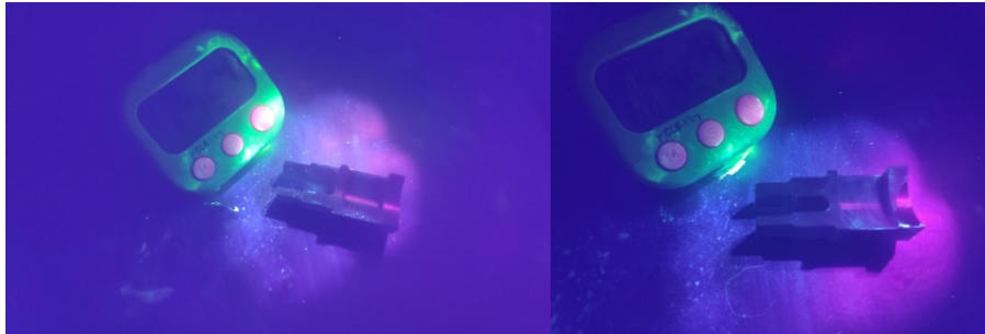
Gambar 12 False indication pada Metode A dan Metode C
